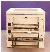
Il vano della carta, con il cassetto di carta aperto per la raccolta in ordine crescente e la sezione della miscelazione che espone il tamburo di toner.
